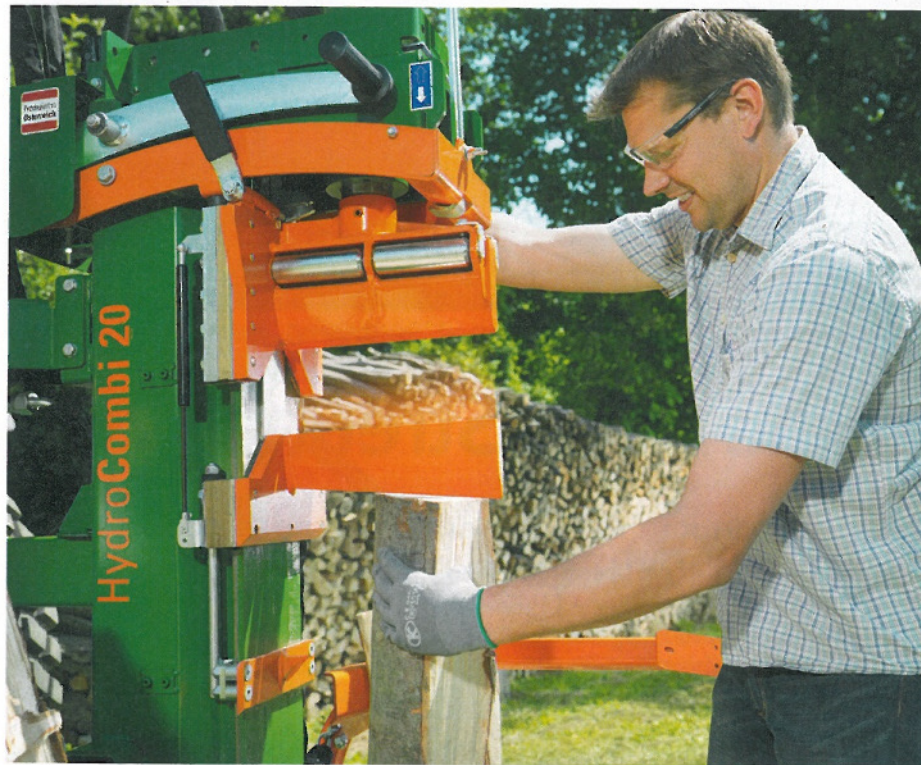
Der HydroCombi 20 mit serienmäßig integriertem Fixomatic-System verhindert das Verrutschen der Holzscheite. ©Posch
