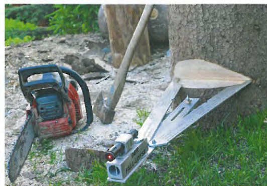
Der Fälllotse, ein Messgerät zur Vorbereitung der Fallkerbanlage, ermöglicht genaues Fällen. ©Feichtner
